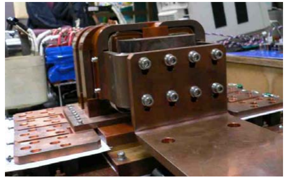
図 9 高周波降圧トランス
